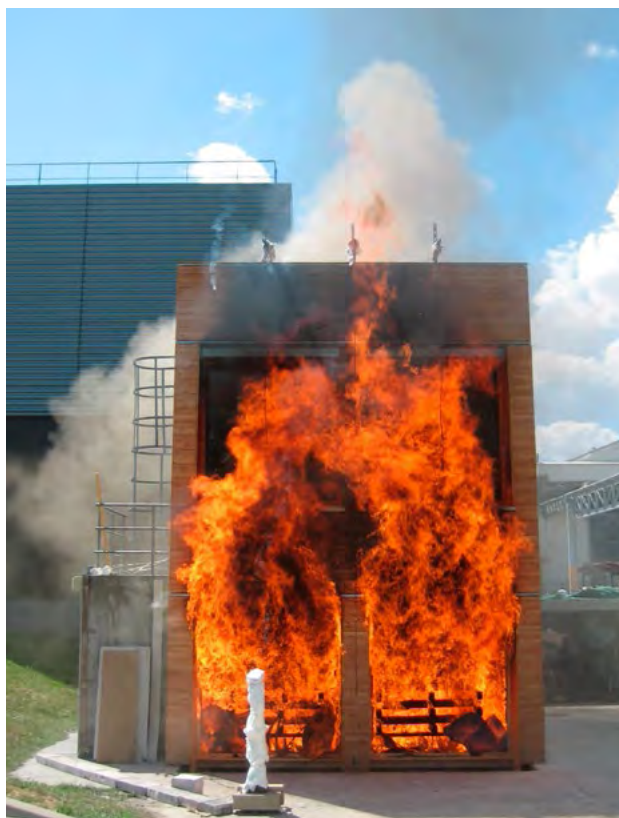
Essai au feu LEPIR 2. Les flammes sont produites par la combustion du bûcher, non par celle des matériaux de construction.
